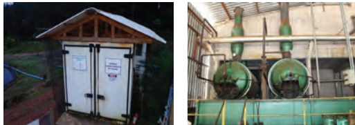
FIGURA 09 | Câmara de congelamento de carcaças de suínos mortos no processo produtivo e produção de farinha de carne e ossos.
