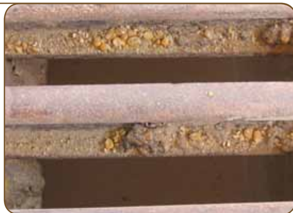
Figuras 20 e 21: Moegas de recepção sujas.
