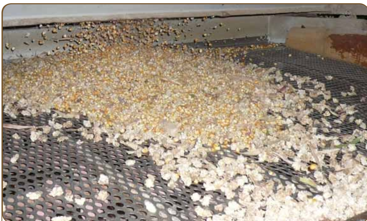
Figura 22: Uso do sistema de pré-limpeza para retirada do excesso de impurezas do milho.
