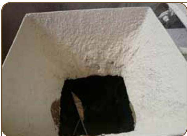
Figuras 25 e 26: Misturador sujo em sua entrada e interior.
