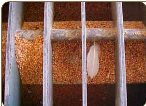
Figuras 20 e 21: Moegas de recepção sujas.
