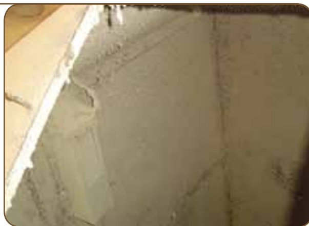
Figuras 25 e 26: Misturador sujo em sua entrada e interior.
