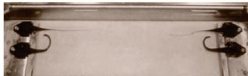
(c) Ruptura do ligante asfáltico
