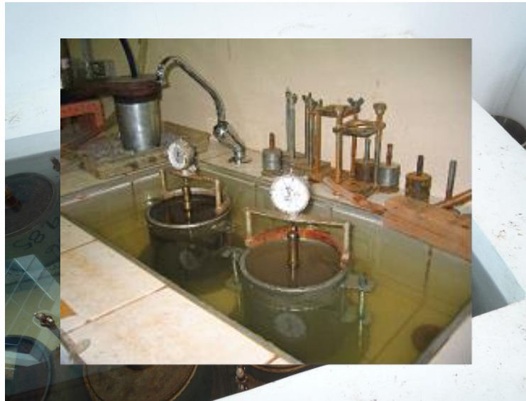
2º. Imersão dos corpos-de-prova em tanque de água por 96 horas e medida de expansão axial
