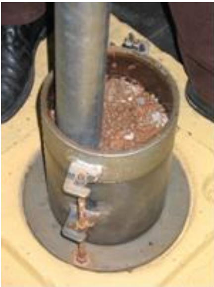
1º. Compactação do corpo-de-prova
