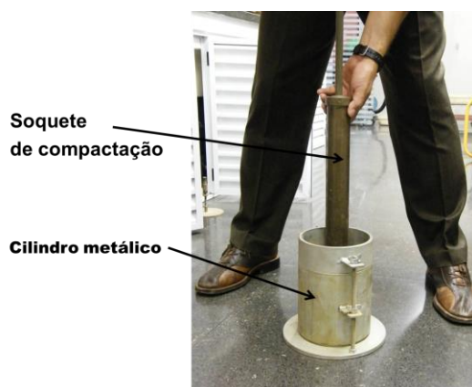
Figura 2 (a): cilindro e soquete de compactação
