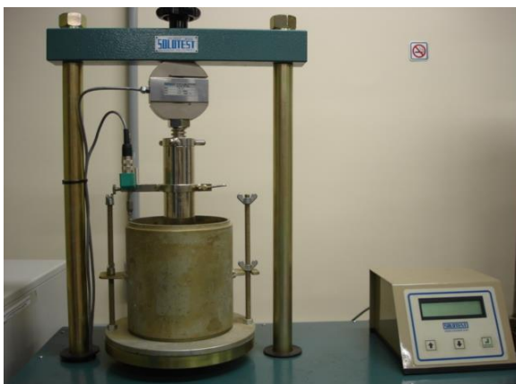
3º Ensaio de penetração de pistão padrão no corpo-de-prova e medida da penetração e resistência
