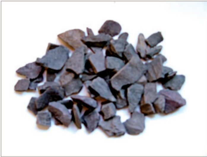
(a) Agregado lamelar
