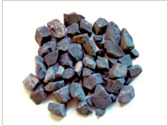
(b) Agregado de boa cubicidade
