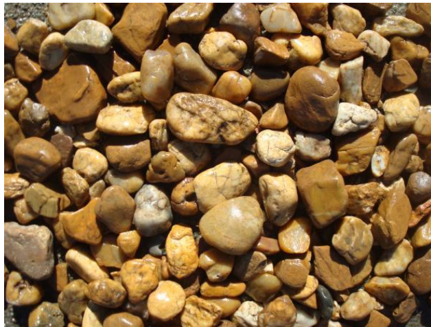
(b) Agregado de boa cubicidade
