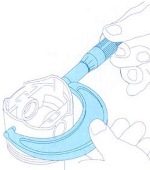
Figura 3.4 – Realizando uma medida com um micrômetro simples.
