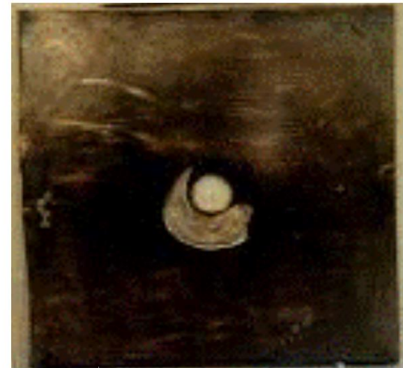
Corrosão em fresta em aço inoxidável 316L
