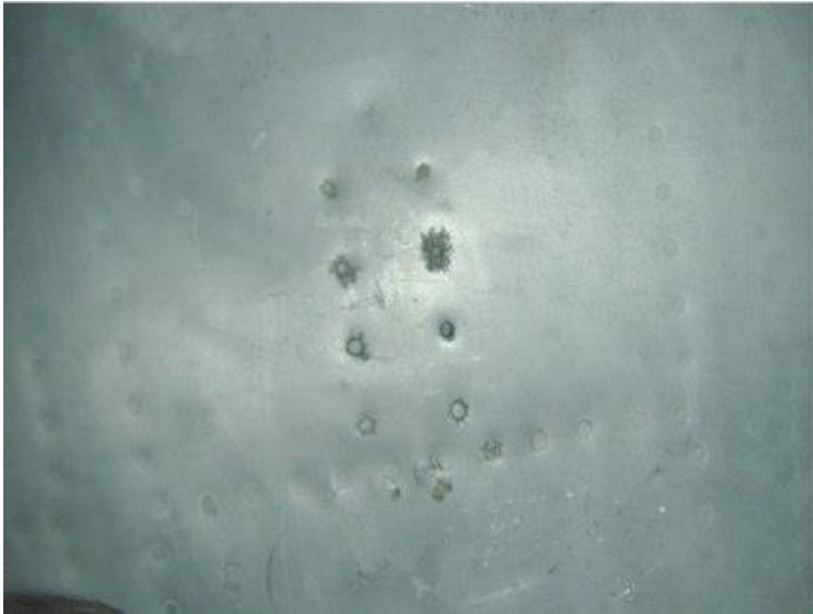
Corrosão em fuselagem de avião com frestas formadas nos rebites que foram mal calafetados
