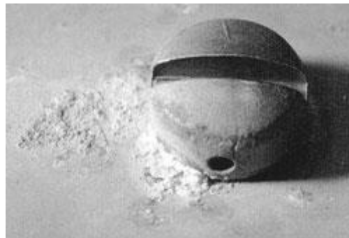
Corrosão galvânica de Al em contato com parafuso de aço inox 304
