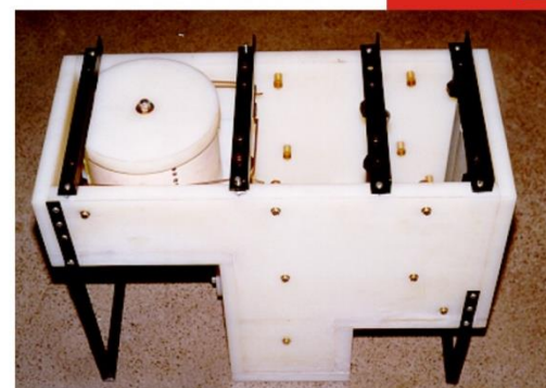
ESTRUTURA DA RETIFICADORA DE ESFERAS DE CERÂMICA - Molde.
