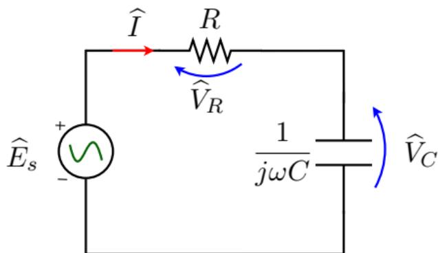
Usando a relação fasorial do capacitor, chega-se ao fasor da tensão no capacitor, ou seja,
