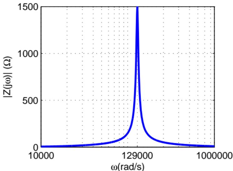
O máximo do módulo ocorre para  $\omega_r = \frac{1}{\sqrt{LC}} = 129100 \text{ rad/s}$  e nessa frequência o circuito se reduz ao resistor  $R = 1500 \Omega$ .
