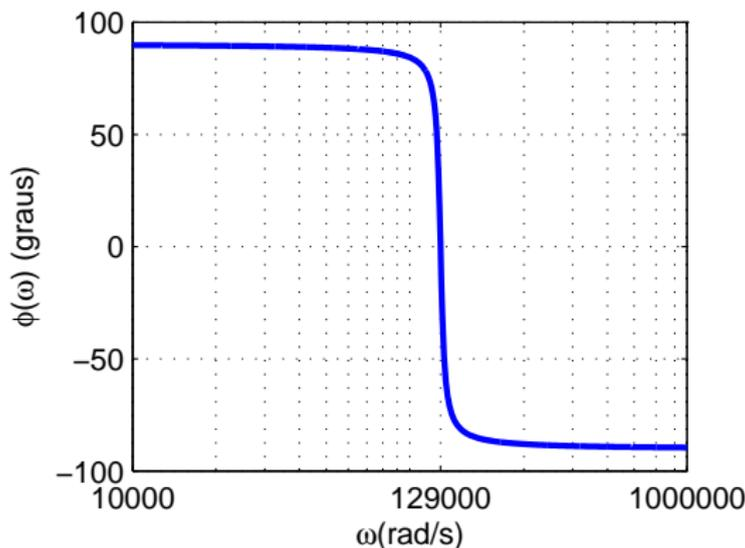
Note que na frequência  $\omega_r = \frac{1}{\sqrt{LC}} = 129100$ , a fase é nula (não há defasagem entre tensão e corrente quando o circuito se reduz a  $R$ ).
