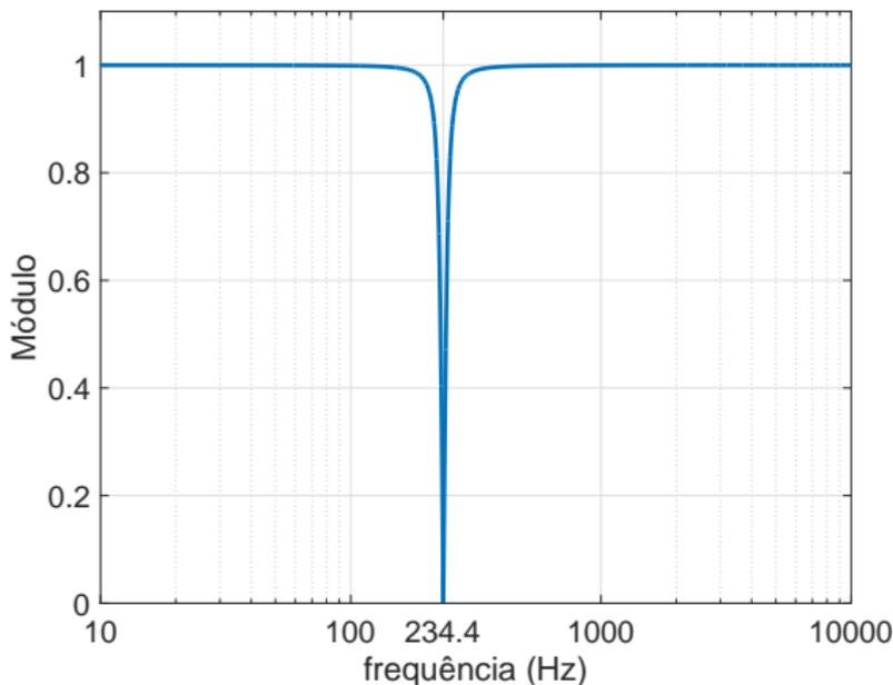
O módulo é zero para  $\omega_r = \frac{1}{\sqrt{LC}} = 1,4727 \text{ krad/s}$ , ou seja,  $f_r = 234,38 \text{ Hz}$ .
