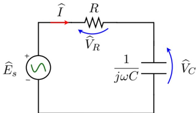
A impedância equivalente da associação série do resistor com o capacitor é
