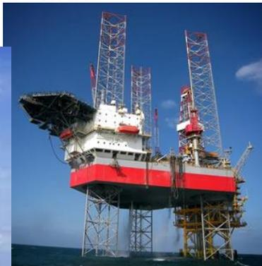
**PLATAFORMA AUTOELEVATÓRIA (JACK-UP):** SÓ PODEM EXISTIR EM ÁGUAS RASAS. SÃO DOTADAS DE TRÊS OU MAIS PERNAS COM ATÉ 150 METROS DE COMPRIMENTO. ESSAS PERNAS SE MOVIMENTAM VERTICALMENTE ATRAVÉS DO CASCO.
