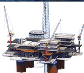
**PLATAFORMA DE PERNAS ATIRANTADAS (TLWP):** DE CASCO SEMELHANTE A UMA SEMI-SUBMERSÍVEL. É ANCORADA NO FUNDO DO MAR POR CABOS OU TENDÕES DE AÇO TRACIONADOS (ATÉ 1.500M).
