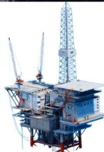
**PLATAFORMA FIXA:** FUNCIONAM COMO UM EDIFÍCIO. CRAVADAS COM ESTACAS, SÃO AS MAIS COMUNS ATÉ 100 METROS DE PROFUNDIDADE. SERVEM COMO PLATAFORMAS DE PRODUÇÃO E PERFURAÇÃO, E PODEM SER DE AÇO E DE CONCRETO (ATÉ 300M).
