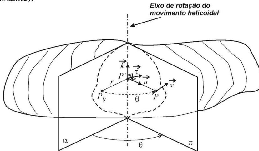
Seja um ponto  $P$  qualquer do sólido e  $P'$  definido como a projeção ortogonal de  $P$  sobre o eixo de rotação (não depende do tempo). Temos, usando os versores mostrados na figura:
