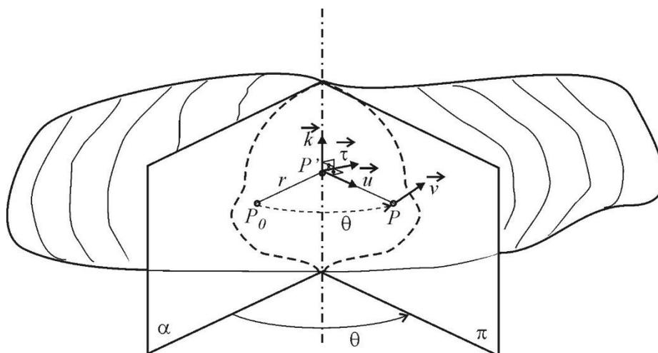
No caso de rotação em torno de um eixo fixo, em qualquer instante todos os pontos à mesma distância do eixo têm a mesma velocidade e aceleração (decorre da rigidez do sólido).
