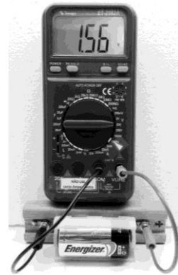
Figura 1-18 – (a) Circuito com uma pilha; (b) Foto da montagem do circuito, onde o Voltímetro indica V=1,56V
