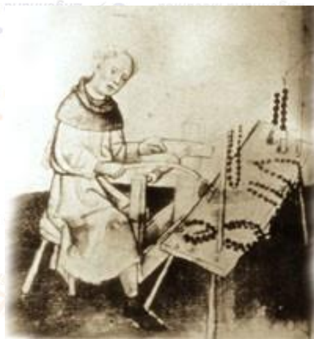
Torno de Gravação equipada com ARC (1435), princípio de operação ainda em uso em alguns países
