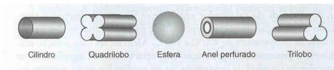
FIGURA 03 – FORMATOS USADOS EM CATALISADORES DE HIDROTRATAMENTO
