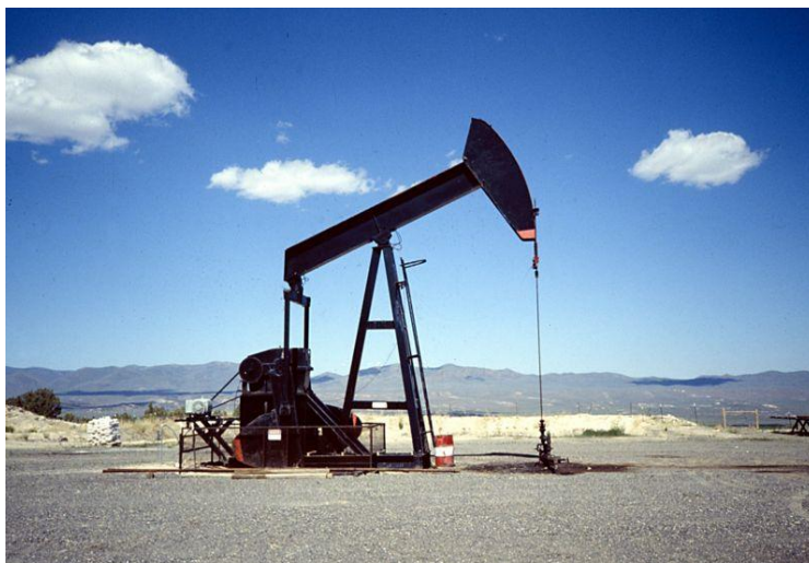
Figura 10 - Bombeamento mecânico de petróleo em terra.
