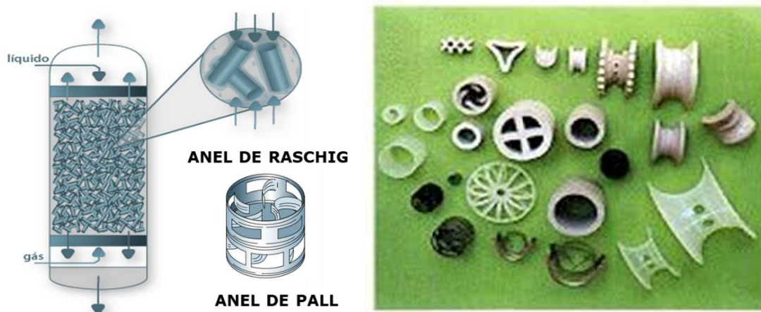
Figura 10 – Tipos de enchimento para coluna de recheio ou coluna absorvedora.
