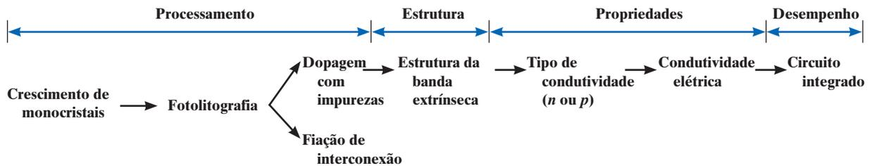
**Figura 18.38** Diagrama esquemático que resume os elementos de processamento, estrutura, propriedades e desempenho para os semicondutores de silício, incluindo componentes da engenharia de materiais.
