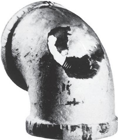
**Figura 17.20** Falha por impingimento de uma conexão que fazia parte de uma linha de vapor condensado. (Esta fotografia é uma cortesia de Mars G. Fontana. De M. G. Fontana, *Corrosion Engineering*, 3ª edição. Copyright © 1986 por McGraw-Hill Book Company. Reproduzido com permissão.)
