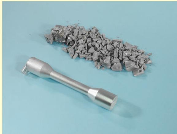
Amostra de estanho branco (esquerda). Outra amostra desintegrada por causa de sua transformação em estanho cinza (direita), após ser resfriada e mantida a uma temperatura abaixo de  $13,2^{\circ}\text{C}$  durante um período de tempo prolongado.
