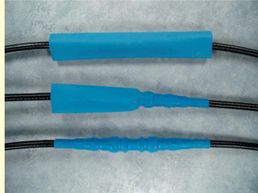
Em cima: Uma conexão elétrica posicionada dentro de uma seção de um tubo polimérico de encolhimento-envolvimento no estado original. No centro e embaixo: A aplicação de calor ao tubo fez com que seu diâmetro encolhesse. Nessa forma retraída, o tubo polimérico estabiliza a conexão e fornece isolamento elétrico.
