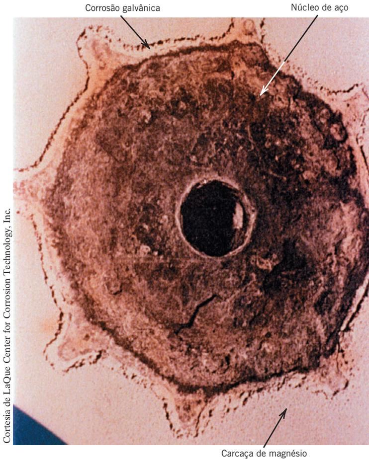
**Figura 17.14** Fotografia que mostra a corrosão galvânica ao redor da entrada de uma bomba de drenagem de estágio simples encontrada em embarcações pesqueiras. A corrosão ocorreu entre uma carcaça de magnésio que foi fundida ao redor de um núcleo de aço.
