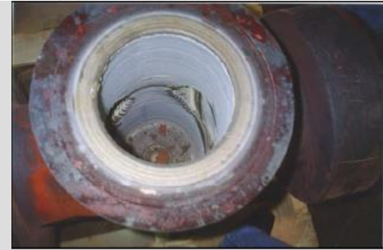
Revestimento interno contra corrosão (Inconel) de válvula de 4130
