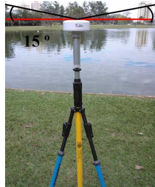
Figura 13 Mascará de elevação, para recepção do sinal GPS, para diminuir erro de multicaminhamento
