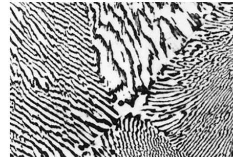
Microestrutura de uma liga chumbo-estanho com composição eutética
