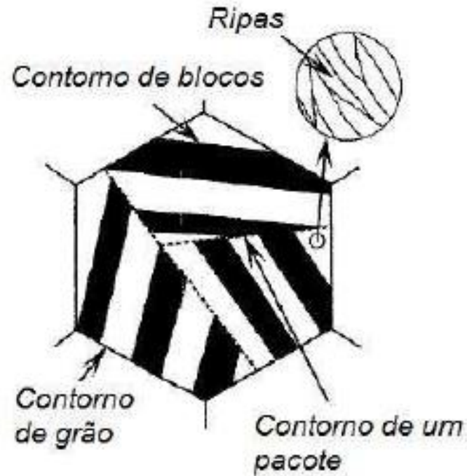
Figura 14: Martensita na forma de ripas e sua estrutura(29).
