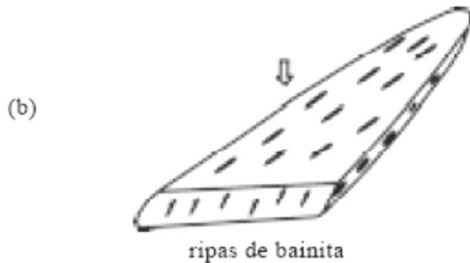
Figura 2 Esquema da precipitação de carbonetos na interface ferrita/austenita na bainita inferior, segundo Ohmori [56]
