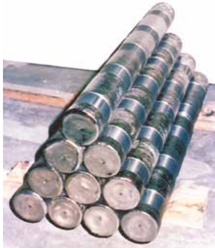
Figura 4 | Pilha de lingotes de Nb, qualificados de acordo com as normas ASTM vigentes à época. Fonte: [2]
