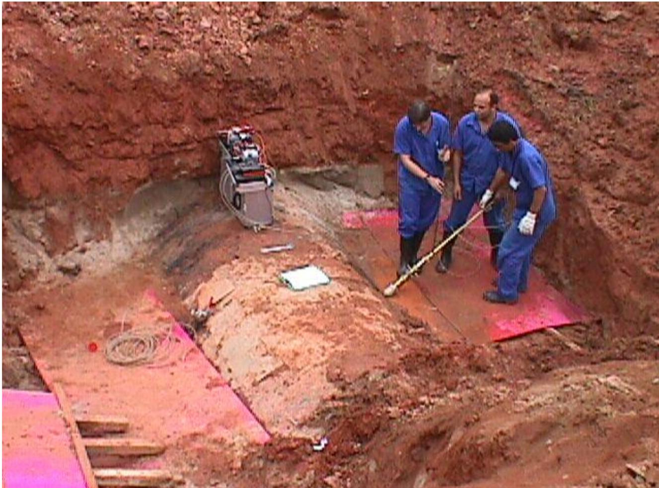
**Medição com Pitot, vazão de  $10 \text{ m}^3/\text{s}$**
