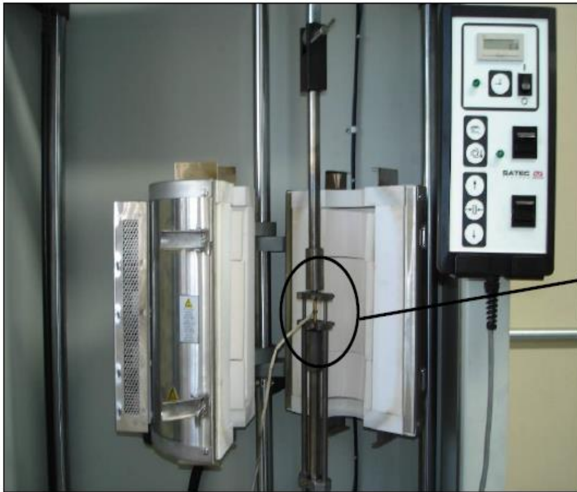
Figura 9.3 Corpo de prova com extensômetro no interior do forno bipartido, mostrando no detalhe a fixação do termopar. (Fotos: Laboratório de Ensaios Mecânicos da EEL-USP).
