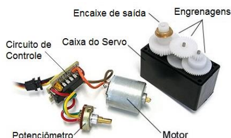
Figura 2 – Organização interna de servomotores.
