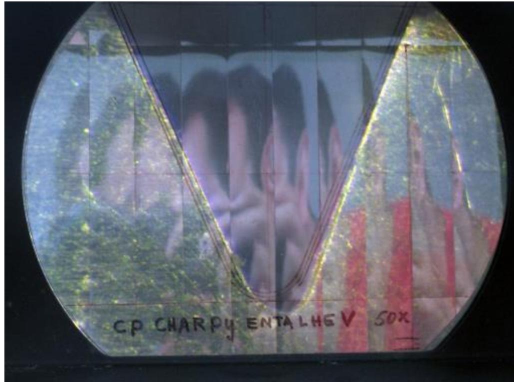
Tanto a **profundidade** quanto o **raio de curvatura** da extremidade do entalhe têm efeito significativo no comportamento a fratura do material
