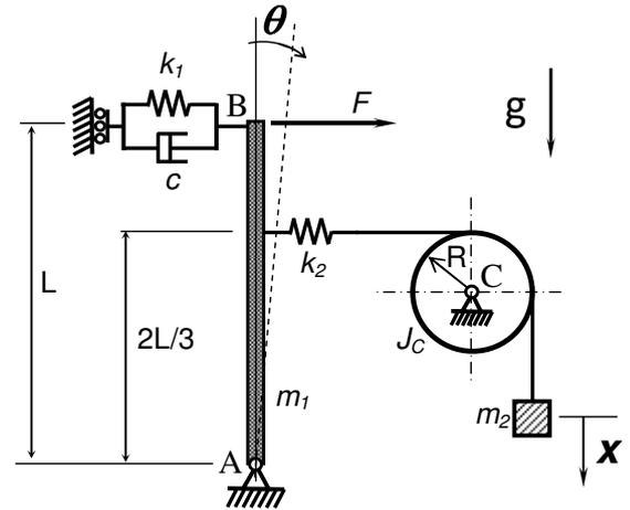
A mola com rigidez  $k_1$  e o amortecedor estão montados sem restrições de movimento na vertical, de forma que o conjunto permanece na horizontal para qualquer valor de  $\theta$ . Adicionalmente, considere que o fio tem comportamento ideal e que a distância entre a barra  $AB$  e o centro da polia é grande o suficiente a ponto de se poder considerar que a mola com rigidez  $k_2$  também permanece na horizontal.
