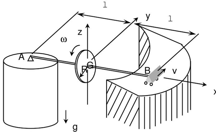
19) Um carro tem motor instalado transversalmente e está fazendo uma curva de raio  $R$ , com velocidade escalar constante  $v$ . As partes móveis do motor podem ser representadas dinamicamente por um rotor que gira com vetor de rotação  $\vec{\omega} = \omega \vec{u}$ , sendo dados  $J_u$ ,  $J_\tau$  e  $J_k$  sendo  $\vec{u}$ ,  $\vec{\tau}$  e  $\vec{k}$  os eixos principais de inércia deste rotor. Pede-se, durante a curva mostrada na figura:
