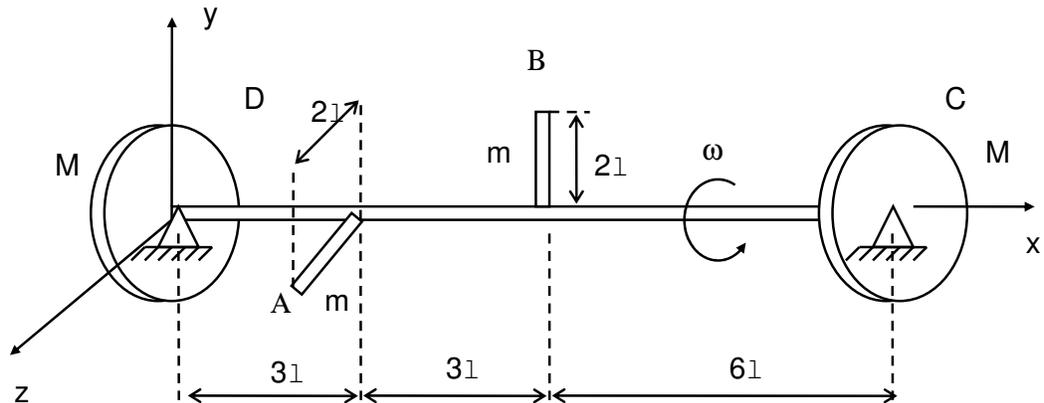
11) Duas barras de massa  $m$  e comprimento  $L$  estão ligadas a um eixo que gira com velocidade angular constante, como indicado na figura. Os volantes A e B, de massa  $M$ , raio  $R$  e espessura desprezível, estão fixados ao eixo. Considerando o sistema  $Axyz$ , solidário ao volante, pede-se:
