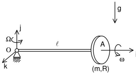
Resp.: a)  $\vec{\omega}_{\text{abs}} = \omega \vec{i} + \Omega \vec{j}$     b)  $\vec{K}_O = \frac{mR^2}{2} \omega \vec{i} + \left( \frac{mR^2}{4} + m\ell^2 \right) \Omega \vec{j}$
