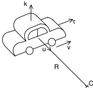
Resp.: a)  $\vec{K}_G = J_u \omega \vec{u} - J_k \frac{v}{R} \vec{k}$       b)  $\vec{M}_G = -\frac{J_u \omega v}{R} \vec{\tau}$
