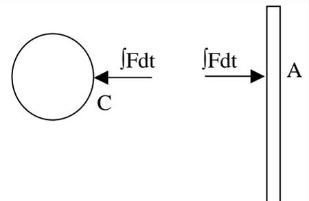
Teorema do Impulso no disco: O impulso sobre o disco é horizontal portanto não há variação de quantidade de movimento do disco na vertical e assim  $\vec{u}' = u'\vec{i}$ .
