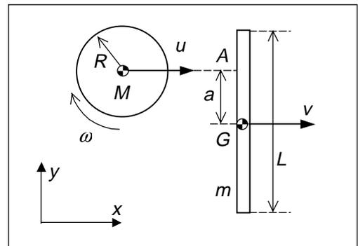
Teorema do Impulso na barra: O impulso sobre a barra é horizontal portanto não há variação de quantidade de movimento da barra na vertical e assim  $\vec{v}' = v'\vec{i}$ .
