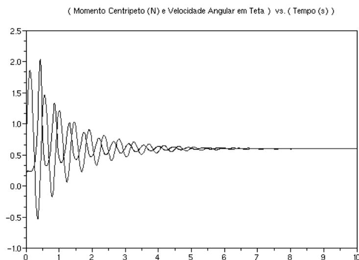
O produto do momento  $M_c$  pela velocidade  $\dot{\theta}$  é uma potência. A integral no tempo de uma potência é trabalho realizado  $W$ . Se o trabalho realizado for negativo, então o momento  $M_c$  dissipa energia, conforme observado na figura abaixo.
