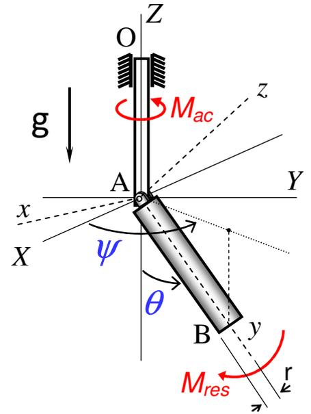
por um torque de acionamento  $\vec{M}_{ac} = \left[ M - b \frac{1}{|\dot{\psi}| + tol} \right] \vec{K}$  e por um torque resistivo  $\vec{M}_{res} = -c\dot{\theta}\vec{i}$
