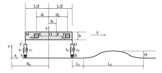
Após percorrer uma distância  $L_l$ , o veículo tem de suplantar um obstáculo em sua trajetória. Durante a passagem pelo obstáculo, a velocidade horizontal do ponto O permanece constante  $\vec{V} = V\vec{i}$ . O pavimento tem altura definida por:
