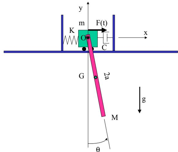
(a) As equações que regem este sistema dinâmico usando  $x(t)$  e  $\theta(t)$  como coordenadas generalizadas são:
