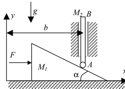
a) o valor da força  $F$  responsável pelo equilíbrio estático do sistema, supondo a ausência de atrito entre a peça triangular e o plano horizontal.
