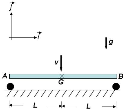
Uma barra homogênea  $AB$  de massa  $m$  e comprimento  $2L$  cai, mantendo-se horizontal, até se chocar simultaneamente com dois anteparos, conforme a figura. Imediatamente antes do choque a velocidade do baricentro da barra é  $v$ . Não há atrito nos pontos de contato e os anteparos são feitos de materiais diferentes, de modo que os coeficientes de restituição  $e_A$  e  $e_B$ , respectivamente dos pontos  $A$  e  $B$ , são diferentes. Pede-se:
