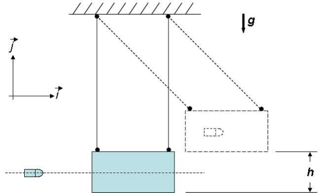
i) O choque é perfeitamente plástico: bala e bloco terão a mesma velocidade  $v'$  após o choque;
