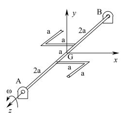
$2^a$  Questão (3,5 pontos) — O dispositivo da figura é formado por barras de massa  $\rho$  por unidade de comprimento e gira com velocidade angular constante  $\omega$ . Pede-se determinar as reações dinâmicas nos mancais.
