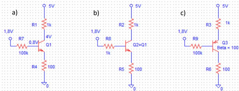
2) **Exemplo 5.1:** O transistor no circuito da Figura 4.11(a) tem  $\beta = 100$  e exibe um  $v_{BE}$  de 0,7 V quando  $i_C = 1 \text{ mA}$ . Projete o circuito de modo que uma corrente de 2 mA circule pelo coletor e a tensão no coletor seja de +5 V .
