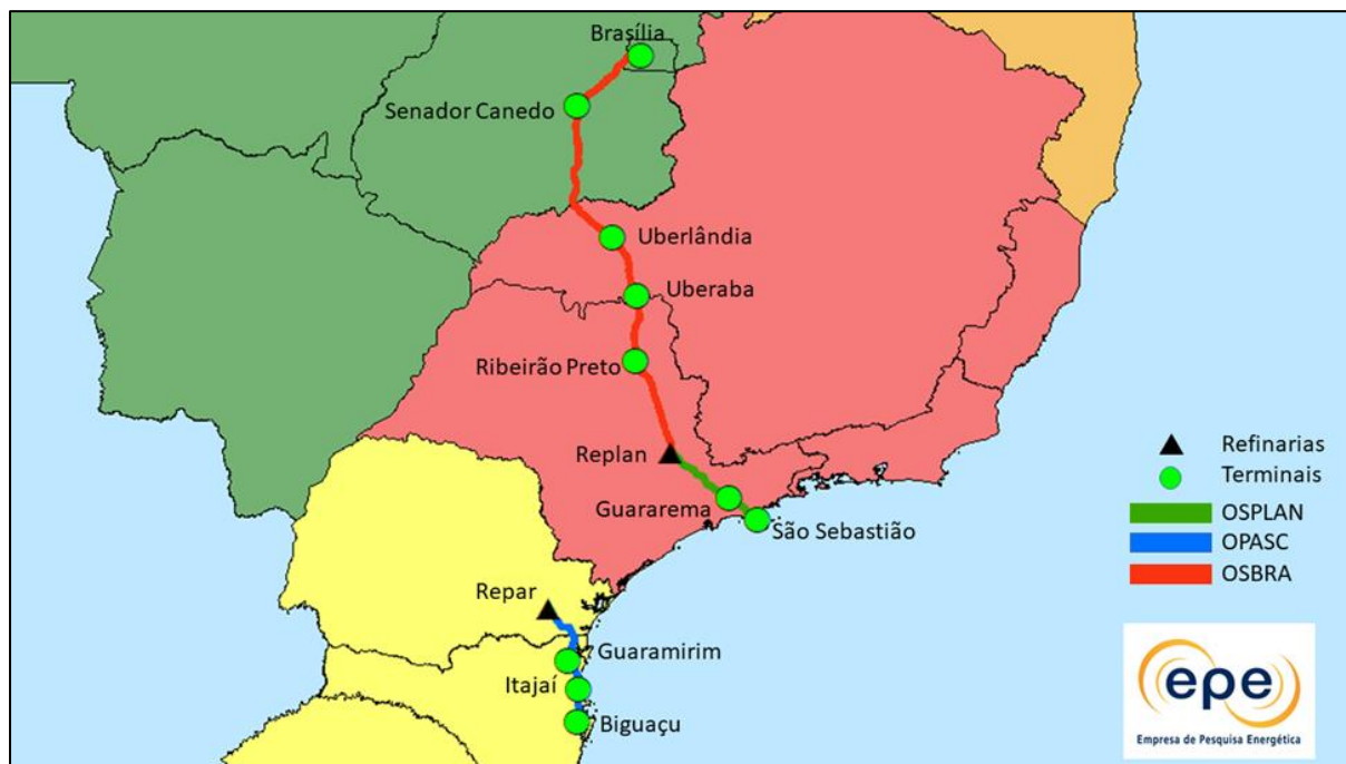
Figura 6-5 - Oleodutos de transporte que atingem o limite da capacidade no horizonte decenal
