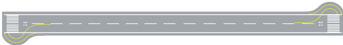
Figura C-1B. Disposição típica de uma área de giro de pista de pouso e decolagem. (Alterado pela Resolução nº 465, de 13.03.2018)
