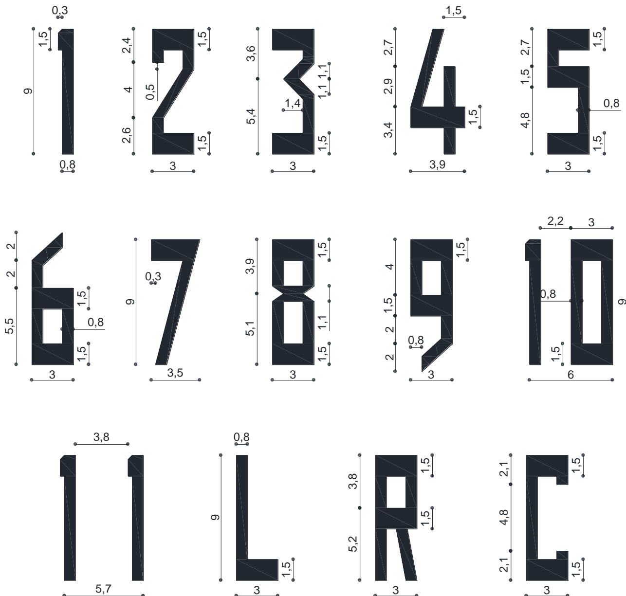
Figura D-3. Formato e proporções dos números e letras para sinalização horizontal de designação de pistas de pouso e decolagem (dimensões em m). (Alterado pela Resolução nº 465, de 13.03.2018)
