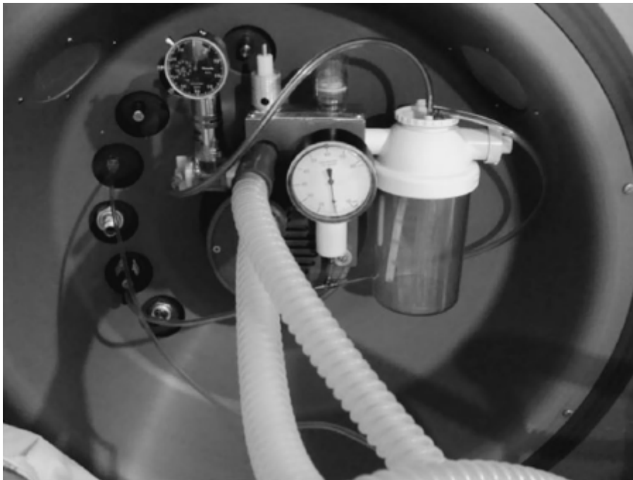
Figura 29.4 Vista interna da porta da câmara com o ventilômetro, o manômetro de pressão relativa das vias respiratórias e o umidificador.
