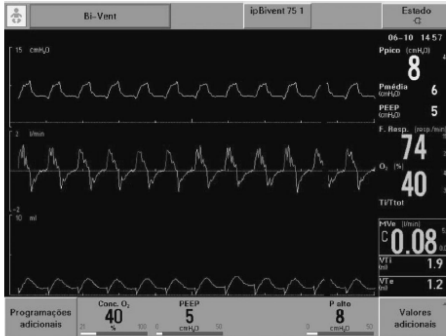
Figura 43.2 Exemplo de tela gráfica de um respirador de última geração em que se observam as curvas pressão \times tempo, fluxo \times tempo e volume \times tempo. Acima das curvas, encontra-se a denominação do modo ventilatório (Bivent), em que há também a identificação, nesse caso, de um animal sob experimento (ipBivent 75 1). Ao lado das curvas, está o monitoramento numérico do que é encontrado nelas: pressão em vias respiratórias (pico, média, PEEP); frequência respiratória; e fração inspirada de oxigênio medida. Abaixo, encontram-se os parâmetros ventilatórios utilizados: PEEP; pressão alta e fração inspirada de oxigênio.
