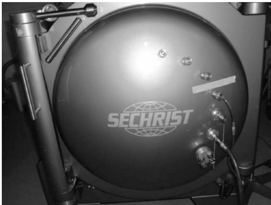
Figura 29.1 Porta da câmara hiperbárica. Vista externa com os passadores para vias venosas e respirador.
