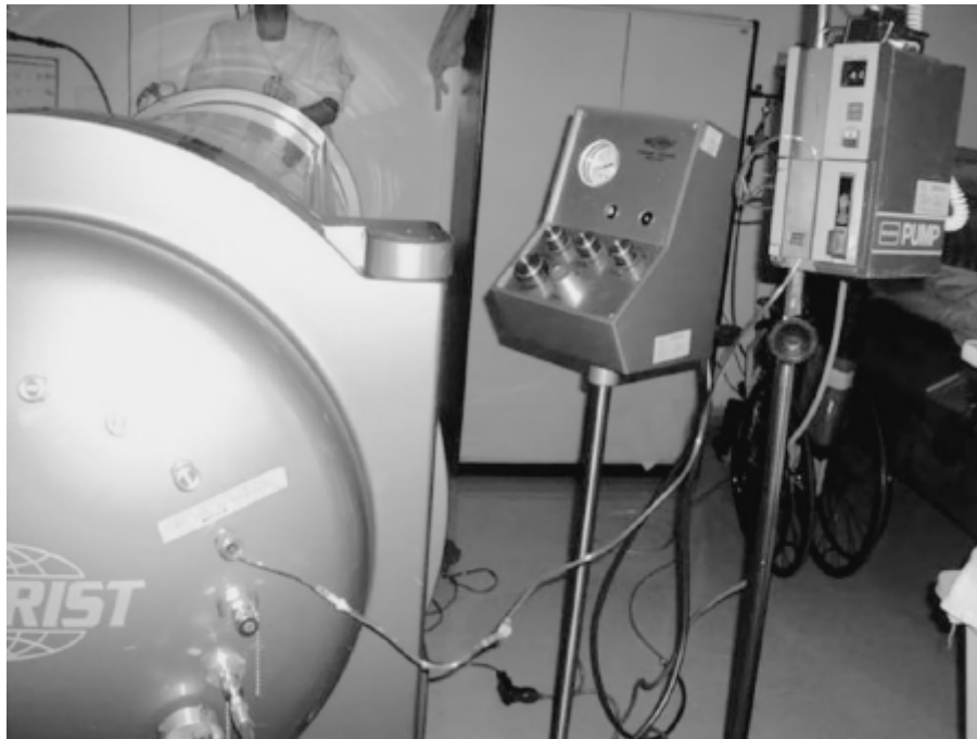
Figura 29.5 Respirador hiperbárico e bomba de infusão hiperbárica acoplados à porta da câmara.
