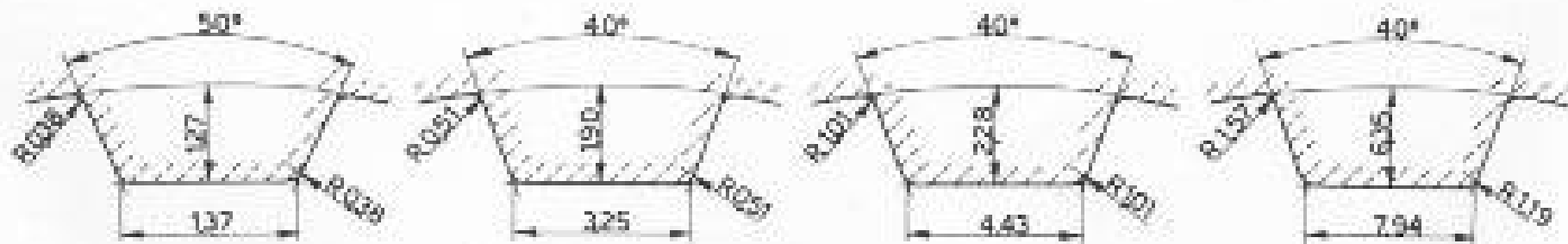
Fig. 3.50 - Dimensões dos quatro tipos de dente das correias POWER GRIP.
