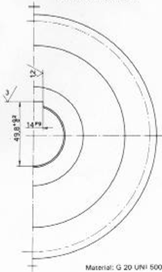
Fig. 3.43 - Exemplo de polia para correias trapezoidais: Polia 4 R 180 UNI 5266.
