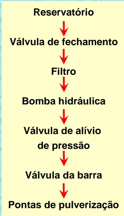
**Pulverizador com controle eletrônico de aplicação**
