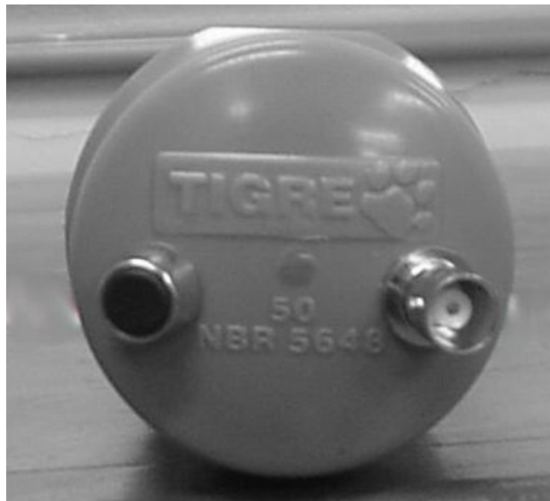
Figura 12 – Sonda Hall. À direita está o conector BNC, e à esquerda o botão de acionamento.
