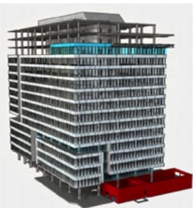
Figura 95: Códigos de cores associados a componentes BIM de modelos de edificações aplicados pelo software Synchro
