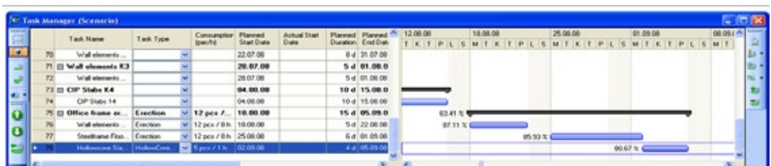
Figura 108: Gerenciador de tarefas criado através do desenvolvimento de uma API no software Tekla Structures
