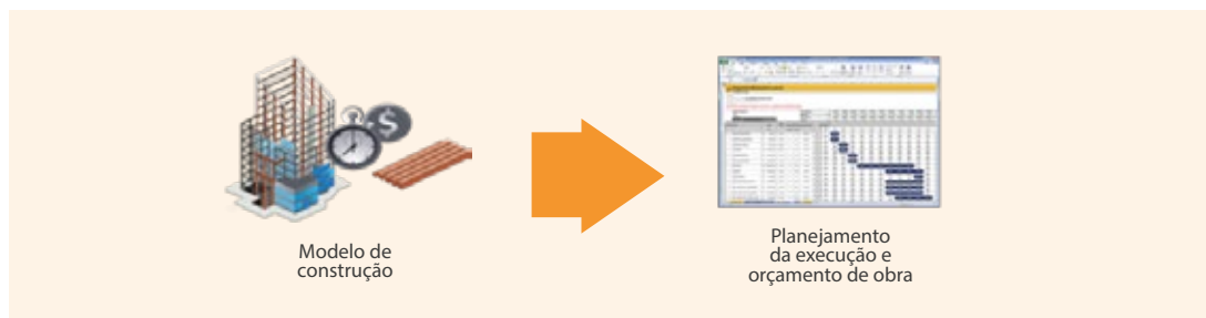
Figura 45: Modelos BIM específicos para construção são desenvolvidos com a finalidade de fazer o 'ensaio da construção', servindo também como base para o planejamento 4D
