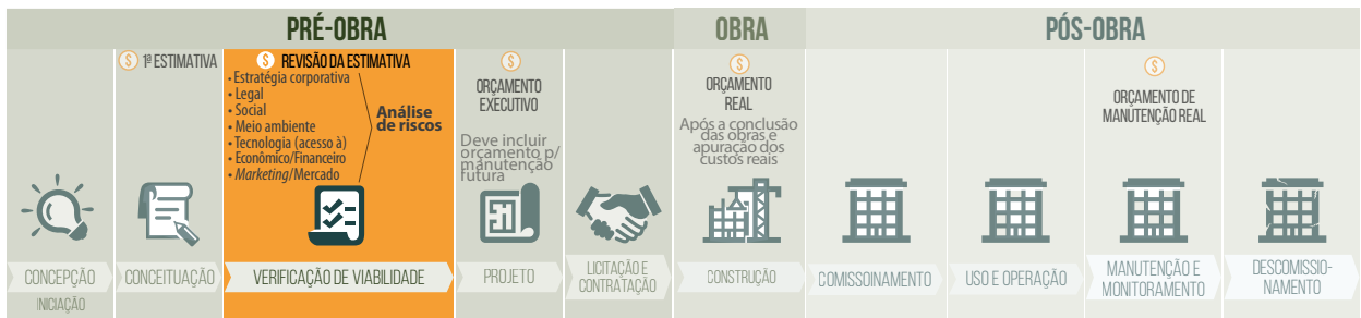
Figura 91: Representação do ciclo de vida de um empreendimento típico da construção civil, com destaque para a 2ª estimativa de custos realizada na fase de “verificação da viabilidade” de um projeto. A própria realização dos processos de verificação da viabilidade pode fornecer informações mais detalhadas sobre o empreendimento, possibilitando a revisão da 1ª. estimativa de custos
