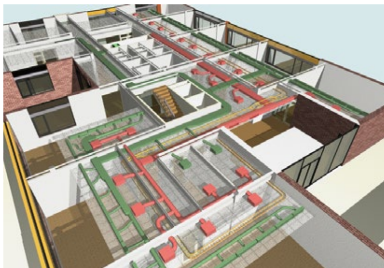
Figura 5: Imagem 3D renderizada, gerada por software BIM, representando parte das instalações de ar condicionado de uma edificação
