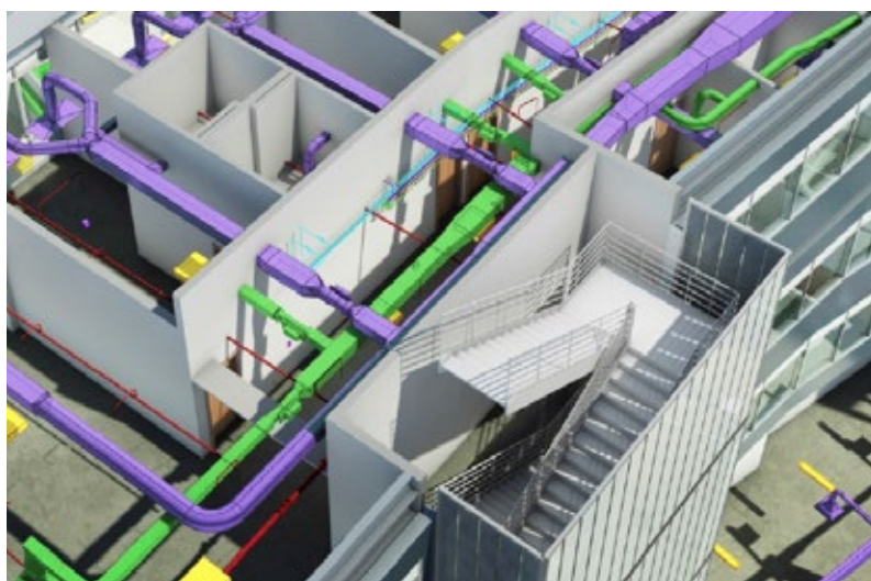
Figura 6: Imagem 3D renderizada, gerada por um software BIM, representando parte das instalações de ar condicionado de uma edificação
