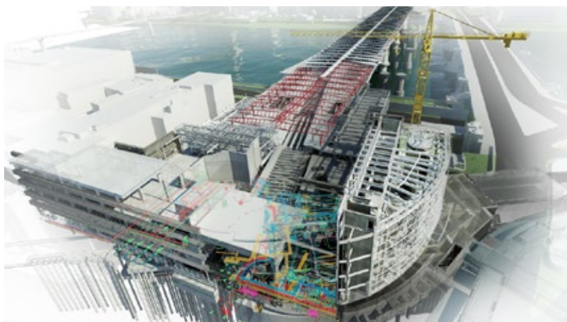
Figura 7: A imagem 3D renderizada, gerada por um software BIM, ensaia as diferentes fases de construção de uma edificação e o funcionamento de uma grua, ou seja, um equipamento (ou recurso) que não será incorporado na edificação, mas será utilizado na construção
