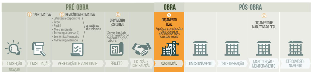
Figura 93: Orçamento real, correspondente ao ‘as built’ e obtido somente após a conclusão e a entrega de uma obra, quando todos os custos reais incorridos podem ser contabilizados. Os dados auferidos devem ser utilizados para a revisão e a atualização dos processos e referências de estimativas anteriores
