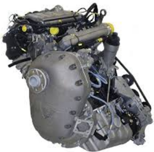
Figura: Motor 4 Tempos, 4 Cilindros, Diesel - Utilizado no Diamond Da-42
