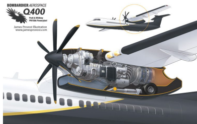
Figura: Ilustração do motor turbo-hélice na aeronave Bombardier Q400
