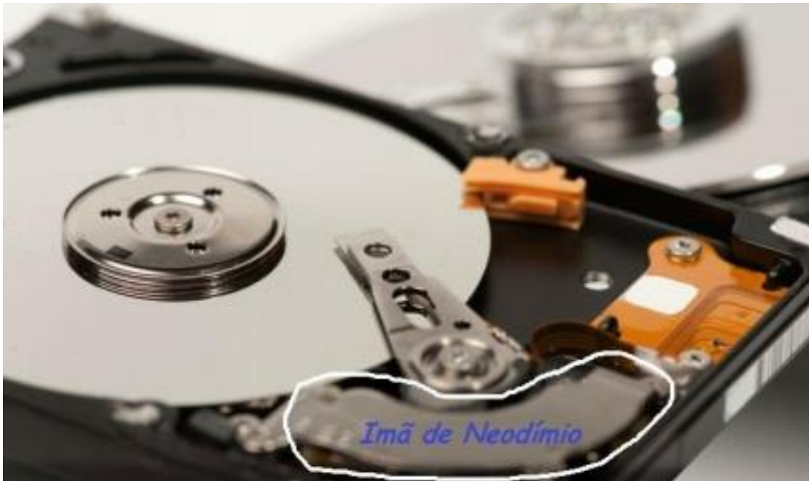
Figura 4: Imagem indicativa da localização do ímã de neodímio no HD de computador. Disponível em: https://www.zoom.com.br/pc-computador/deumzoom/o-que-e-um-hd . (adaptado de zoom, 2020)
