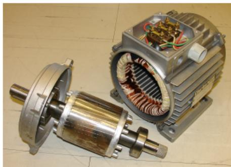
Fig.: Rotor gaiola de esquilo e estator (imagem real).
