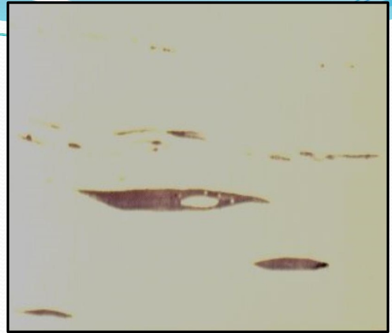
INCLUSÕES DE SULFETO- 1000X
